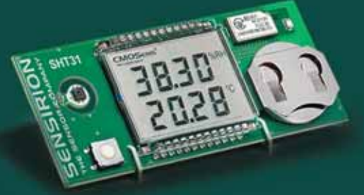
Nem Sıcaklık Sensörü Uygulama Kiti SHT31
