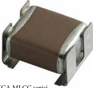
Şekil 5: Murata'nın KCA MLCC serisi, daha küçük bir alana daha fazla kapasitans sığdırıyor
